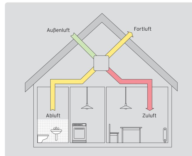
Aus Küche, Bad und WC wird Abluft abgesaugt, und ihre Wärme wird über einen Wärmetauscher auf die Zuluft übertragen, die das Luftkanalsystem in Wohn- und Schlafräume transportiert.
