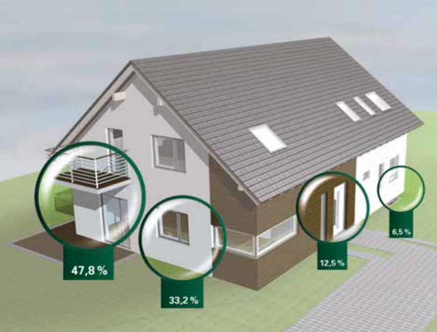
einbruchgefährdete Bereiche am Einfamilienhaus
